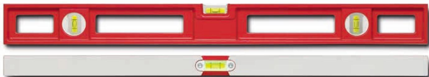
Schwere Aludruckguss-Wasserwaage, umlaufend gefräst. Rot pulverbeschichtet. Sehr hohe Verwindungssteifigkeit. Durchgriffe für leichte Handhabung. Messgenauigkeit in Normallage 0,5 mm/m. Die Längen 060 S und 080 S sind mit zwei V Libellen ausgestattet.
