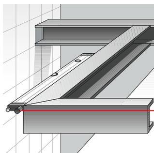
2 Messingrändelschrauben garantieren eine feste Verbindung
