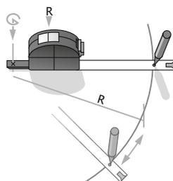
Durch einen ausklappbaren Zirkeldorn können Kreise bis zu 6 m Durchmesser gezeichnet werden
