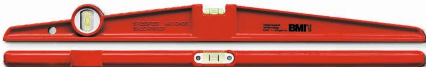
Schwere Aludruckguss-Wasserwaage in Trapezform. Messfläche gefräst. Wasserwaagenkörper rot pulverbeschichtet. Sehr hohe Verwindungssteifigkeit. Messgenauigkeit in Normallage 1,0 mm/m.
